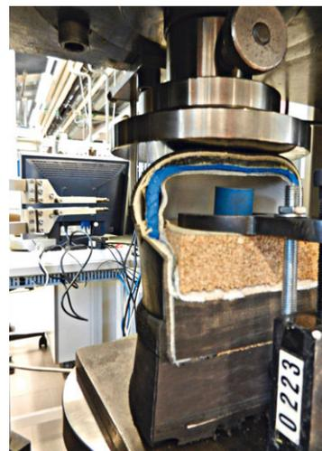
Bei der Druckprüfung werden die Zehenschutzkappen mit 15 kN (15 000 N) zusammengedrückt. Für die Prüfung wird der Schuh vorne abgeschnitten und in das Prüfgerät eingespannt. Foto: PFI
