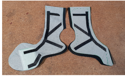
4 Nach dem Anzeichnen und Ausschneiden aller Einzellagen wird das Laminat mittels Punktschweißen fixiert. In der Mitte des Laminatquerschnitts werden die Verstärkungen eingelegt. Darüber schichtet man in spiegelbildlicher Reihenfolge nochmal dieselben Einzellagen, wie sie bereits darunter liegen.
