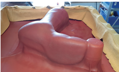
6 Das Laminat wird gemeinsam mit den beiden Silikonmatten unter der Infrarotheizung erwärmt. Wenn das Laminat an der Unterseite überall 180°C erreicht hat kann der Tiefziehvorgang erfolgen.
