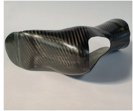
9, 10, 11 Die entformten und bearbeiteten Halbschalen (L). Im Bereich der späteren Schweißnaht ist eine Überlappung vorhanden. Die beiden Halbschalen werden jetzt zwischen Trennfolie auf den Leisten gesteckt und in der Tiefziehmaschine unter Vakuum verschweißt. Dies geschieht mit einem Heißluftfön durch eine 1mm dicke Silikonmatte hindurch. Nach vollständiger Abkühlung kann ausgeleitet werden (m. und re.)
