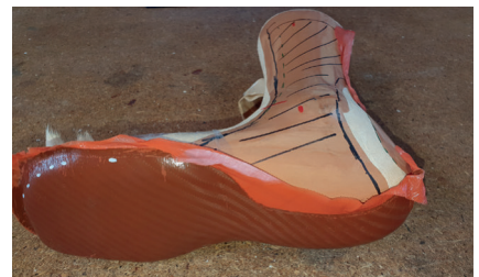
8 Die Kanten können jetzt besäumt werden. Danach wird das Laminat auf den Leisten gesteckt, um die Gegenseite herzustellen. Die zweite Halbschale wird in gleicher Weise hergestellt.
