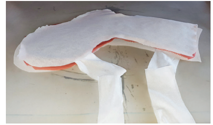
5 Das Laminat für die mediale Halbschale wird gemeinsam mit den notwendigen Hilfsmitteln wie Trennfolie und Ansaugvlies sowie Absaugkanälen zwischen 2 Silikonmatten in die Tiefziehmaschine eingelegt und unter Vakuum gesetzt.
