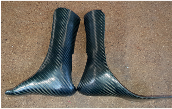
9, 10, 11 Die entformten und bearbeiteten Halbschalen (L). Im Bereich der späteren Schweißnaht ist eine Überlappung vorhanden. Die beiden Halbschalen werden jetzt zwischen Trennfolie auf den Leisten gesteckt und in der Tiefziehmaschine unter Vakuum verschweißt. Dies geschieht mit einem Heißluftfön durch eine 1mm dicke Silikonmatte hindurch. Nach vollständiger Abkühlung kann ausgeleitet werden (m. und re.)
