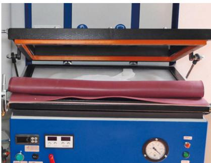
**37** Eine zweite Silikonmatte wird deckungsgleich zur ersten aufgelegt und mit dem Rahmen der Tiefziehmaschine verspannt. Durch den Entlüftungsrahmen hindurch kann die Luft zwischen den beiden Matten abgesaugt werden, sodass das Laminat im Vakuum liegt. Die obere rotbraune Matte ist hitzebeständiger als die untere transparente, denn sie liegt nahe an der Heizung und wird dadurch viel stärker belastet.
