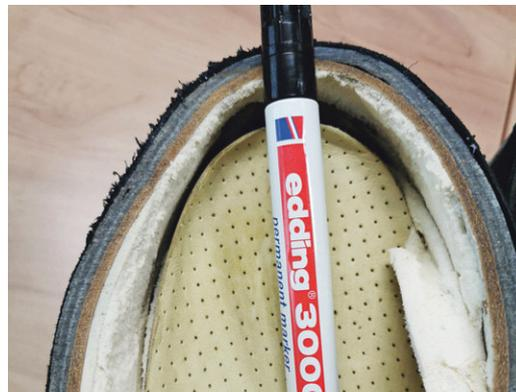
27 Beispiel aus einer Prüfung für übertriebene Wandstärke. Lederkappe, Versteifungsmaterial (doppelt) und Polster betragen zusammen etwa 10 Millimeter.
