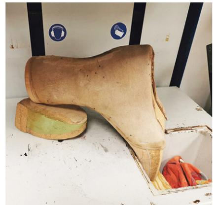
**16** Positionierung des Leistsens im Tiefziehgerät.
