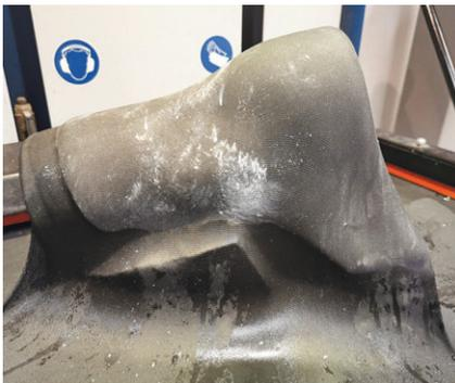
**17** Tiefziehen. Bei Max können beide Schichten in einem Durchgang tiefgezogen werden.
