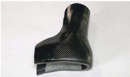
48 Bei der Herstellung der Kappe kann zwischen einer glatten (hier außen) und einer rauen Oberfläche (hier innen) gewählt werden. Raue Oberflächen ersparen die Vorbereitung zum Verkleben, glatte Oberflächen bieten bei Innenschuhen und Orthesen eine ansprechendere Optik.
