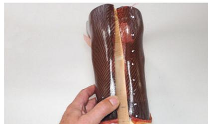
44 Beide Halbschalen haben hinten einen Überlappungsbereich, der gegebenenfalls noch etwas begradigt oder gekürzt werden kann. Dieser bildet die Fläche zum Verschweißen. Die Trennfolie kann bis zum Verschweißen als Schutz auf dem Laminat verbleiben, um bei Sichtoberflächen Kratzer und Bearbeitungsspuren zu vermeiden.
