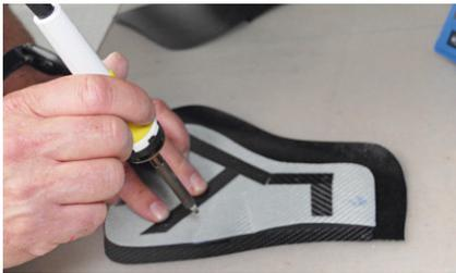
**34** Zur Erleichterung des Handlings werden die Einzelteile passgenau zueinander fixiert. Das geschieht durch Punktschweißen mit einer leicht modifizierten Lötstation. Zur Vergrößerung der Schweißfläche wird die Lötspitze plan geschliffen.
