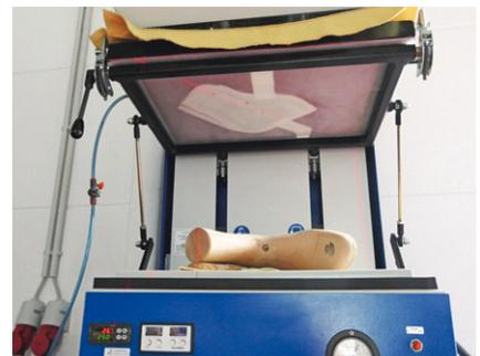
**39** Besonders einfach und gleichzeitig genau funktioniert die Ausrichtung mit einem Kreuzlinienlaser, der in jedem Baumarkt erhältlich ist. Mit etwas Übung reicht jedoch ein geschultes Auge vollkommen aus.
