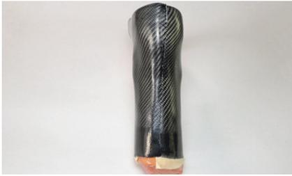
45 Zunächst wird der Leisten großzügig mit Trennfolie belegt, um ein Verkleben der Kappe mit dem Leisten auszuschließen. Dann werden beide Halbschalen auf den Leisten gesteckt, ...
