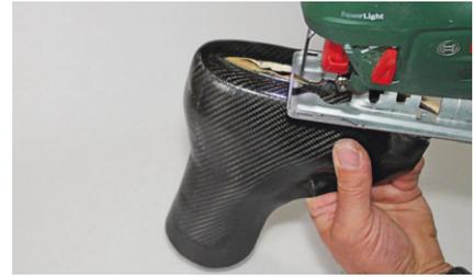
47 Die Endbearbeitung ist schnell erledigt. Der Bereich des Zwickeinschlags wird am einfachsten mit einer Stichsäge und einem speziell dafür vorgesehenen Sägeblatt erledigt. Zum Glätten und Entgraten eignen sich eine Feile und etwas Schleifstein. Die flexiblen Ränder werden mit einer scharfen Schere auf das gewünschte Maß gekürzt.
