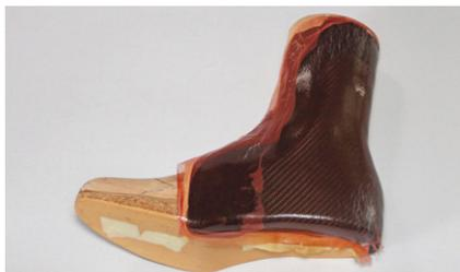
42 Nach vollständiger Abkühlung wird das Laminat entformt.
