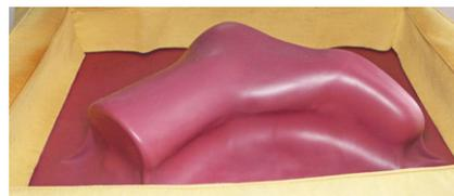
41 Beim Tiefziehvorgang folgt das Laminat der Leistenform. Die Silikonmatten speichern zudem Wärme und ermöglichen damit eine passgenaue Anformung ohne Faltenbildung.
