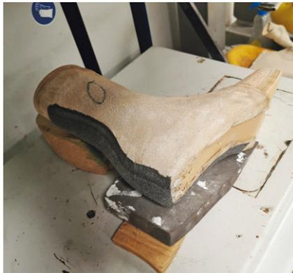
23 Positionierung des Leistens für das Tiefziehen der lateralen Hälfte.
