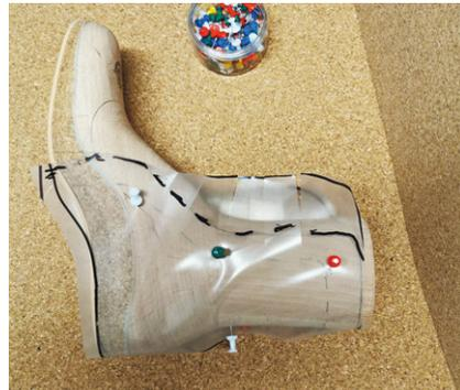
2 Abformung des Leistens mit der Musterfolie.
