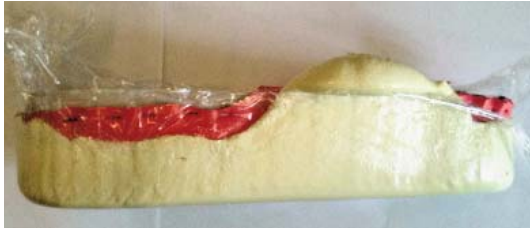
5 Eine Schicht „Hekapur Weichschaum W 200 VE“ wurde aufgebracht.
