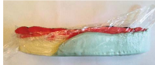
6 Weitere Bereiche in unterschiedlichen Shore-Härten wurden von unten aufgeschäumt.
